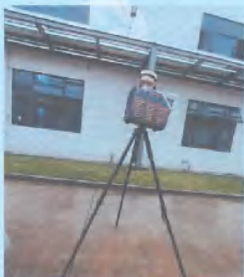
厂界废气无组织排放上风向参照点 G1
